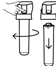
Нажмите до упора и удерживайте стопорную кнопку на крышке водоочистителя, выкрутите использованные модули.
