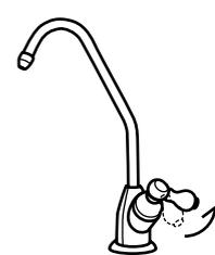
Откройте кран для чистой воды. При помощи узла подключения отрегулируйте расход воды 2,5 л/мин.
