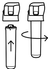
Вставьте новые модули в гнездо коллектора до упора и, слегка надавливая, поверните модули до щелчка.
