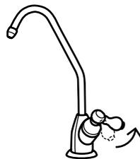
Откройте кран для чистой воды, чтобы сбросить давление внутри фильтра.
